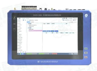
MSPD-3000 配电自动化终端测试仪是我司自主研发的新一代手持式配电终端测试仪器,该设备运用先进的电源和数字电子技术,采用微型高精度电流和电压放大器模块,内置大容量锂电池组供电,具有输出精度高、体积小、重量轻等特点,仪器采用高清全触屏操作,测试功能丰富。基于配电网行业相关标准设计开发,遵循国内行业检测大纲标准,主要用于现场二次回路运维检修,特别是配电终端 FTU、DTU 安装前后的快速调试验收工作。设备具备常规信号和小信号输出,满足配电终端对电磁式和电子式信号混合输入信号需求,支持 IEC101/104 规约测试和验证,独立模拟断路器功能,对配电终端保护动作逻辑进行验证,内置高精 GPS 多台同步功能,支持电压时间型、电压电流型、自适应综合型等就地型馈线自动化测试。
